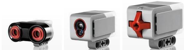
Датчик касания Ультразвуковой датчик Датчик цвета
